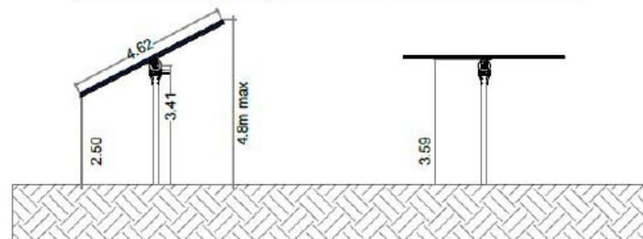
Figure 12 : Coupes et plans de principe des structures et des tables envisagées pour la configuration bovine. (Source : PARC AGRISOLAIRE DE LA CHAMPIGNOLLE)
