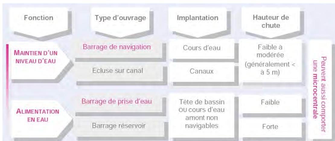
Figure A10. Typologie simplifiée des ouvrages VNF (VNF, 2008)
